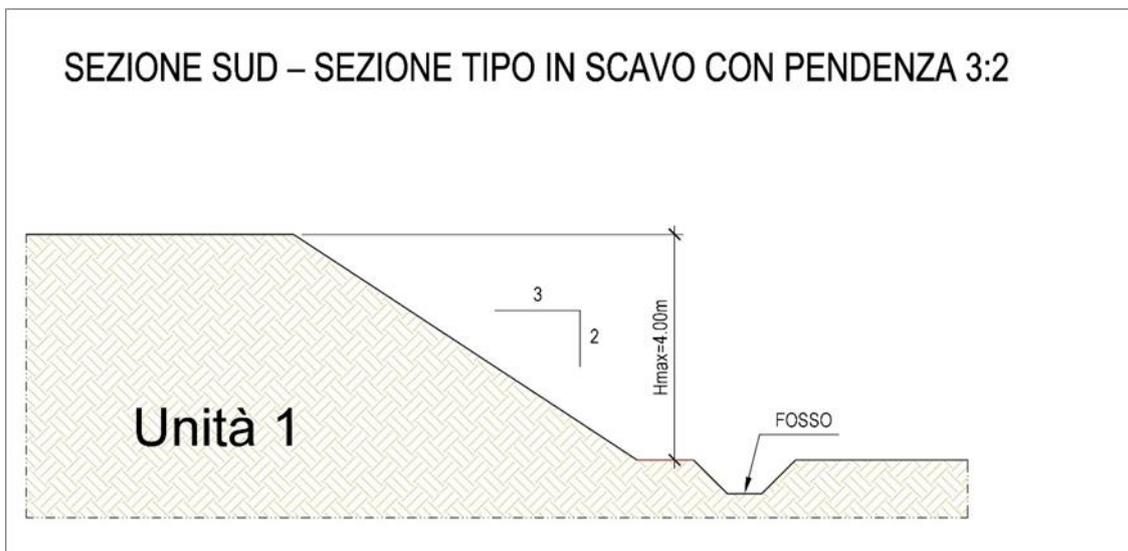
Figura 2-6: Sezione di calcolo 4\_ Sezione Sud in scavo con pendenza 3:2, verifica di stabilità.
